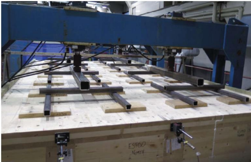
Figure 12 : Mesure du glissement entre les membrures en CLT et les nervures en GLT pendant l'essai au feu 1
